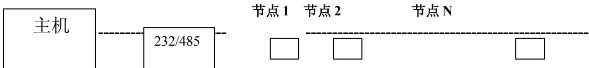
上图为传统老式 RS-485 门禁考勤系统，一般采用总线方式布线，采用这种老式布线结构存在以下几种缺陷：
