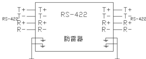
两个 GND 为保护地线，必须将其与设备地一起引接到大地，否则浪涌电流无处释放，达不到保护效果。
